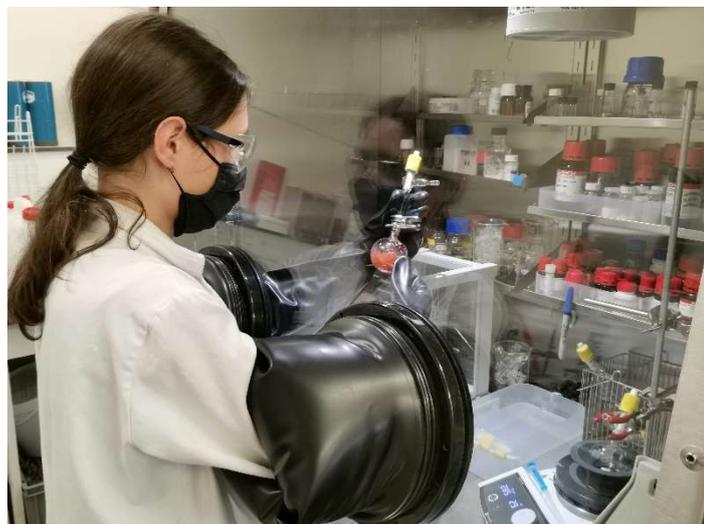
Figure 7 : Mae Robin manipulant dans une boîte à gants
