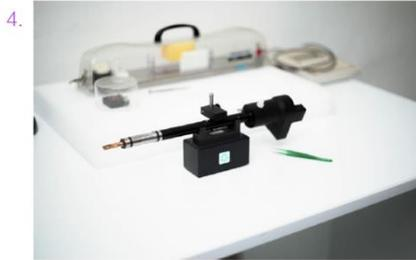
1. Machine de traction pour faire des essais mécaniques dans le MEB : installation d'un échantillon
